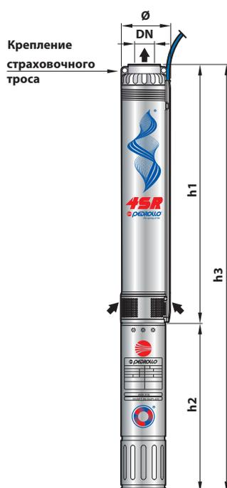
4PD = перематываемый погружной масляный двигатель
